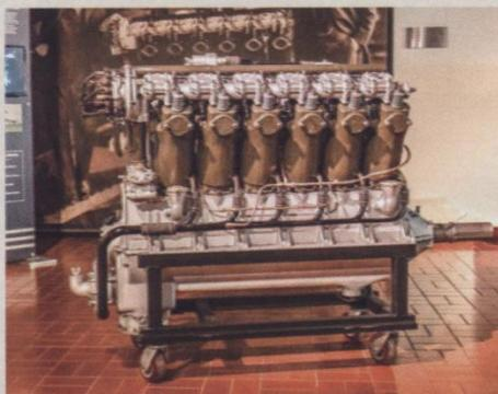
◀ Im Herbst 1917 erteilte das Kriegsministerium den Auftrag über die Produktion von 22.500 Exemplaren des Liberty L12 Flugzeugmotors, der unter Lincoln, Buick, Ford, Cadillac, Marmon und Packard aufgeteilt wurde. Die modulare Bauweise erleichterte die Herstellung durch mehrere Fabriken. Lincoln errichtete in Rekordzeit ein neues Werk ausschließlich für die Produktion von Liberty-Motoren
